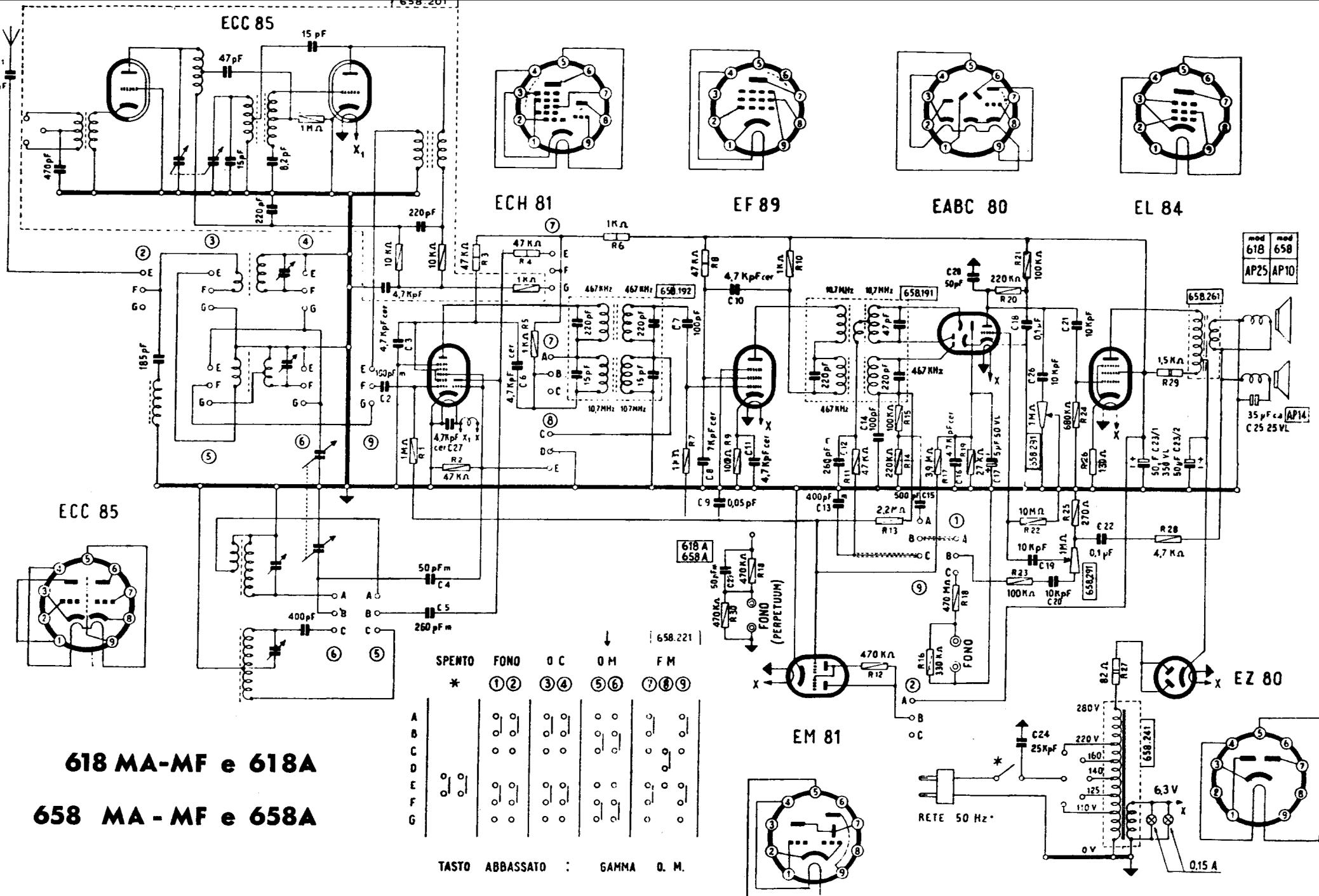
VOCE DEL PADRONE - Modd. 618/618 A e 658/658 A. Radiofonografi a modulazione d'ampiezza e di frequenza. Gamma OM da 560 e 190 m, gamma OC da 25 a 75 m e gamma OUC da 87 a 100 Mc/s. Medie frequenze a 467 kc/s e a 10.7 Mc/s. Potenza d'uscita 3 watt.
